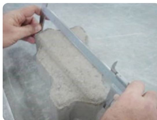
Figura 7 – Exemplo de avaliação dimensional da peça de concreto
