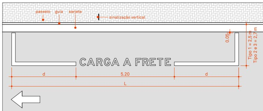
Figura 120. Marcação de área de estacionamento paralelo ao meio fio.
