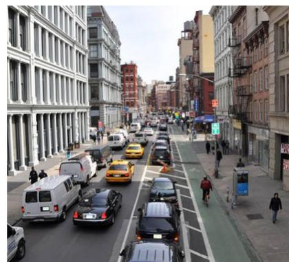
Figura 6. Ciclovía em Nova Iorque, EUA, separada da via por estacionamento e marcas de canalização.
