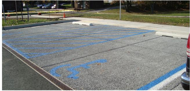
Figura 23. Piso de concreto permeável.
