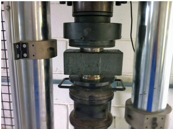
Fotos 7a e 7b - Avaliação dimensional e ensaio de resistência à compressão de peças de concreto para pavimentação
