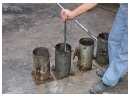
Moldagem de Corpo-de-Prova
