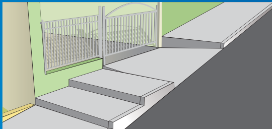
Calçada errada em rua inclinada
