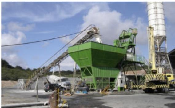
Figura 3 – Usina de concreto transportável, dosadora e misturadora (Schwing M2)
