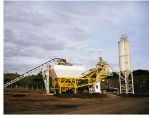
Figura 5 – Usina de concreto transportável, dosadora e misturadora (ARCMOV 100)
