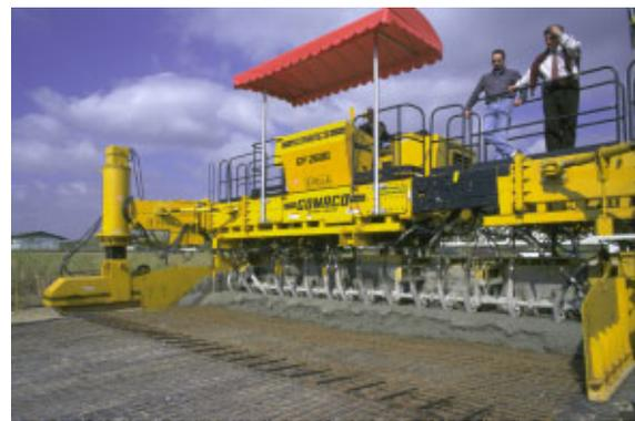
Figura 8 – Gomaco 2600 (4 esteiras)- vibroacabadora de fôrmas deslizantes
