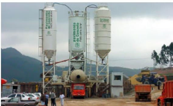
Figura 4 – Usina de concreto transportável, dosadora e misturadora (Erie Strayer MG 11C)
