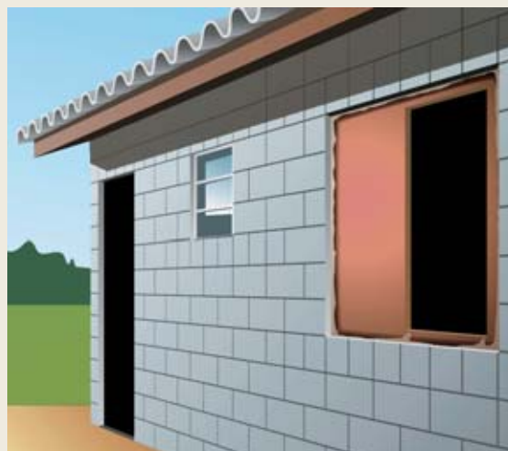
Figura 14 Aplicação de janela com unidade modular compatível com a da alvenaria
