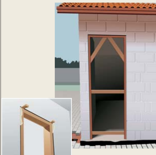
Figura 15 - Aplicação de porta pronta. Detalhe: precisão do vão deixado na execução da alvenaria para aplicação de espuma de poliuretano
