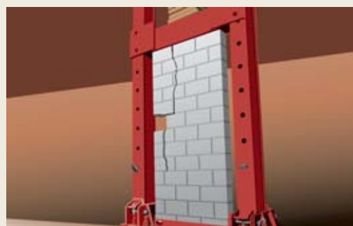
Figura 20 - Ruptura de parede com preenchimento total da junta horizontal
