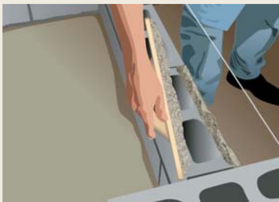
Figura 17 Aplicação da argamassa (Alternativa B)
