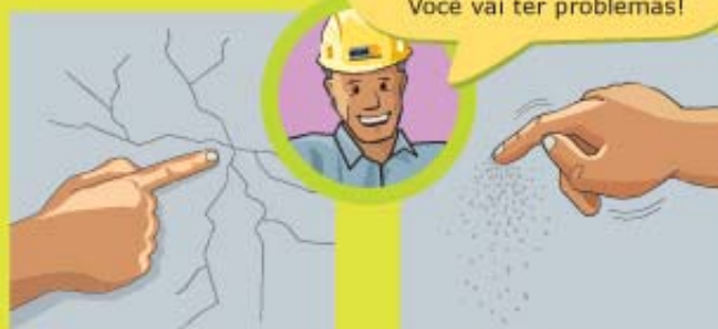
Polvilhar cimento causa fissuras
